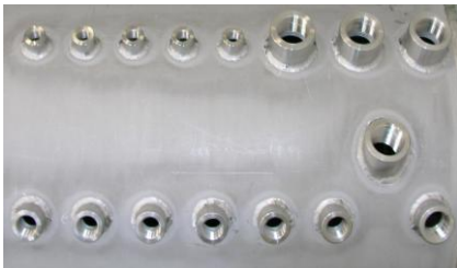
Behälter aus Werkstoff 1.4435 Unbehandelt und chemisch gebeizt und passiviert
