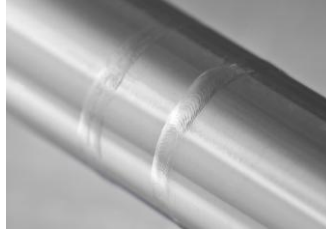
Rohrleitung geschweißt aus Werkstoff 1.4435 Unbehandelt und chemisch gebeizt
