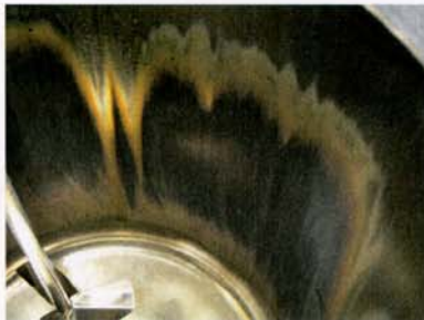
Abb. 1: Beispiele für typische rougebelagte Bauteiloberflächen (Quelle aller Bilder: Henkel).
