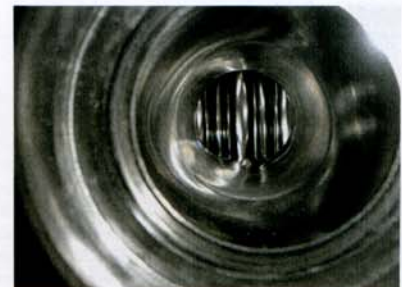
Abb. 3: Beispiel für chemisch derougte Edelstahl Oberflächen mittels neutralem organischem Komplexbildnersystem HENKEL HC 4200.
