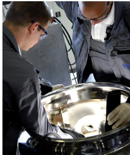
Lokale Nacharbeit von technischen Oberflächendefekten in einem elektropolierten Edelstahlbehälter aus Werkstoff 1.4435 mit Hilfe spezieller elektrochemischer Verfahren
