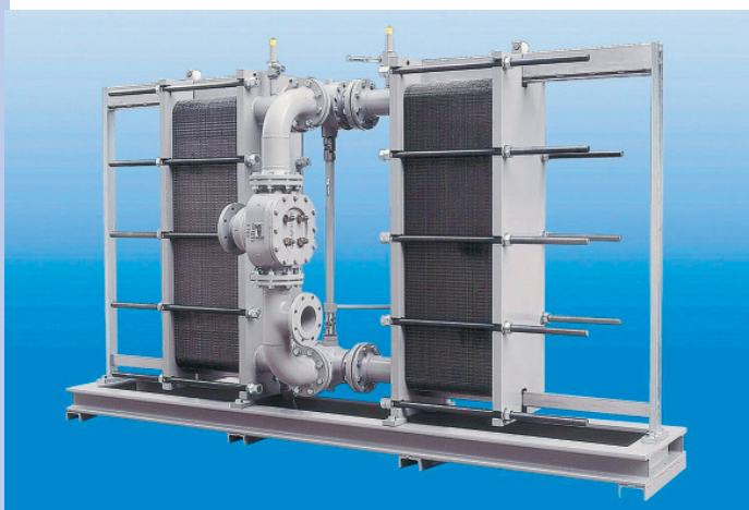
2: Doppelölkühler mit Umschaltarmatur und Temperaturregler zur Turbinenölkühlung
