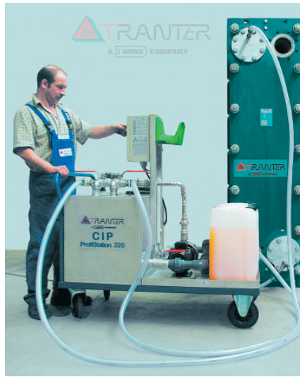
5: Wenig Aufwand, große Wirkung: Die CIP-Reinigung von Wärmeübertragern
