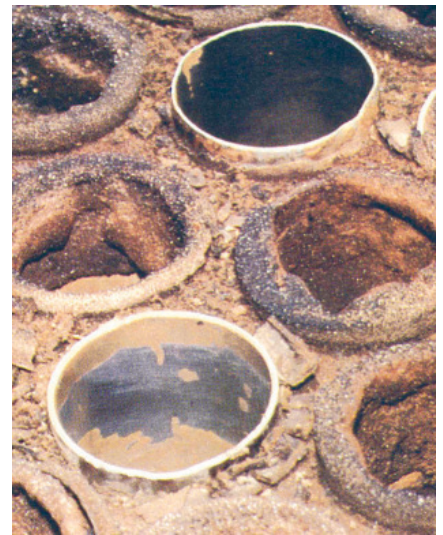
6: Der Unterschied ist deutlich: elektropolierte neben Standardrohre
